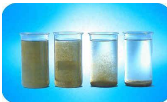
Fig. 1: Tratamiento antes y después con clarificador
