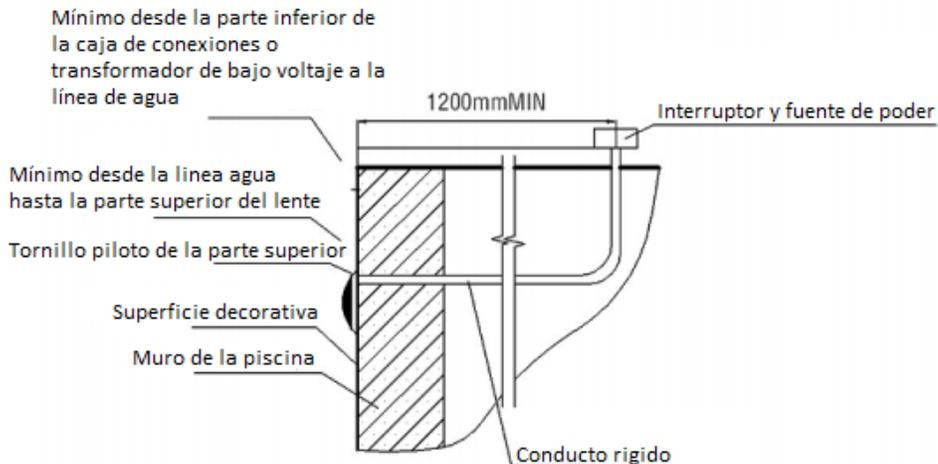
**Nota: No use transformadores eléctricos que puedan dañar el LED. Usted debería usar transformadores de frecuencia industrial.**
